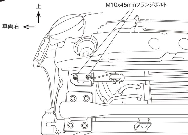
【1】 フロント部の上下に2本あるクロスレールのうち、上側クロスレール取付ボルトを取り外してください。
