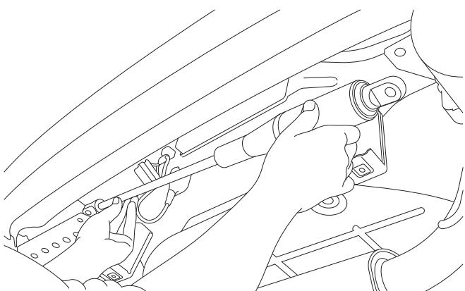
【1】 取付構成イメージ の図に従って、MCB 本体を左右のブラケットに取り付けてください。締め付けトルク=55~59Nm (5.6~6.0kgf-m)
