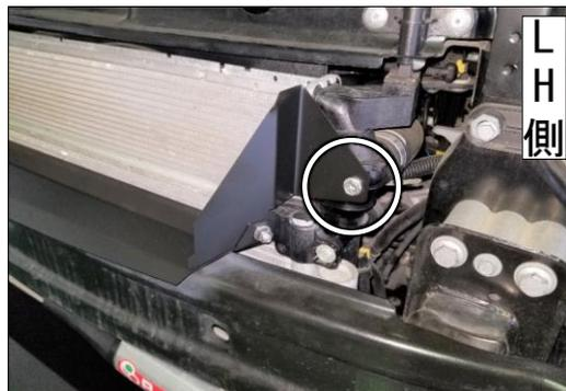
③ 裏にクッションテープのついている部分をレインフォースに押しつけた状態で左右プレートと部品①との隙間を1~2mmほど空くように取付部4箇所を増し締めを行ってください。
