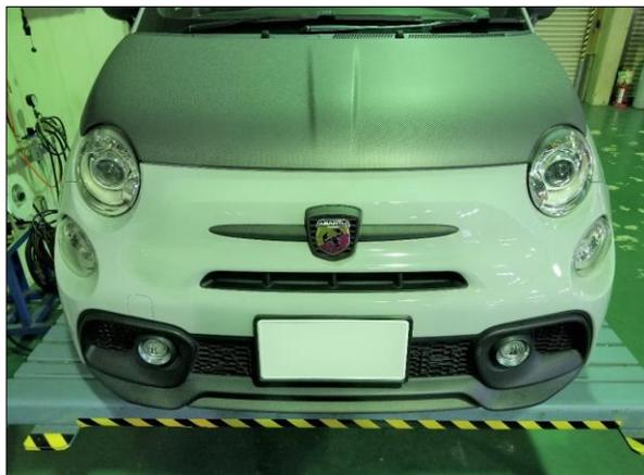
②フロントバンパー装着後、各灯火類の点灯・点滅を確認し、車両を前後に動かし異常が無いか確認後、取付完了です。
